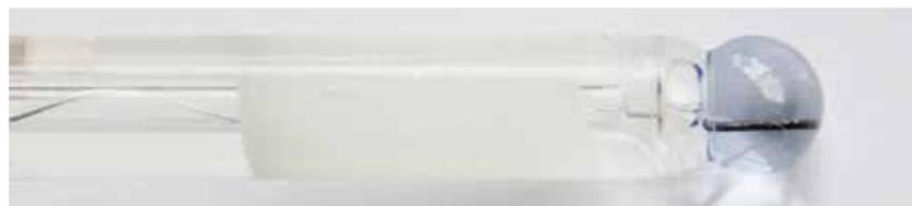
Dieser Fehler kommt durch die Erfassung von Natriumionen als Wasserstoffionen (Querempfindlichkeit) zustande. Er kann unter extremen Bedingungen und bei Einsatz eines weniger geeigneten Membranglases bis zu einer pH-Einheit ausmachen. Hier sollte der Anwender auf ein H-Glas zurückgreifen.
